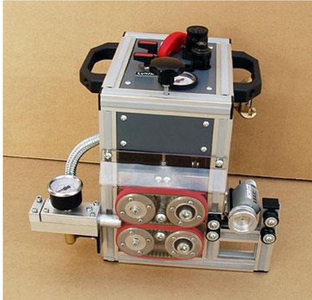
**Macchina per la posa ad aria di mini cavi da 3 mm a 9 mm in mini tubi da 8 a 16 mm**
